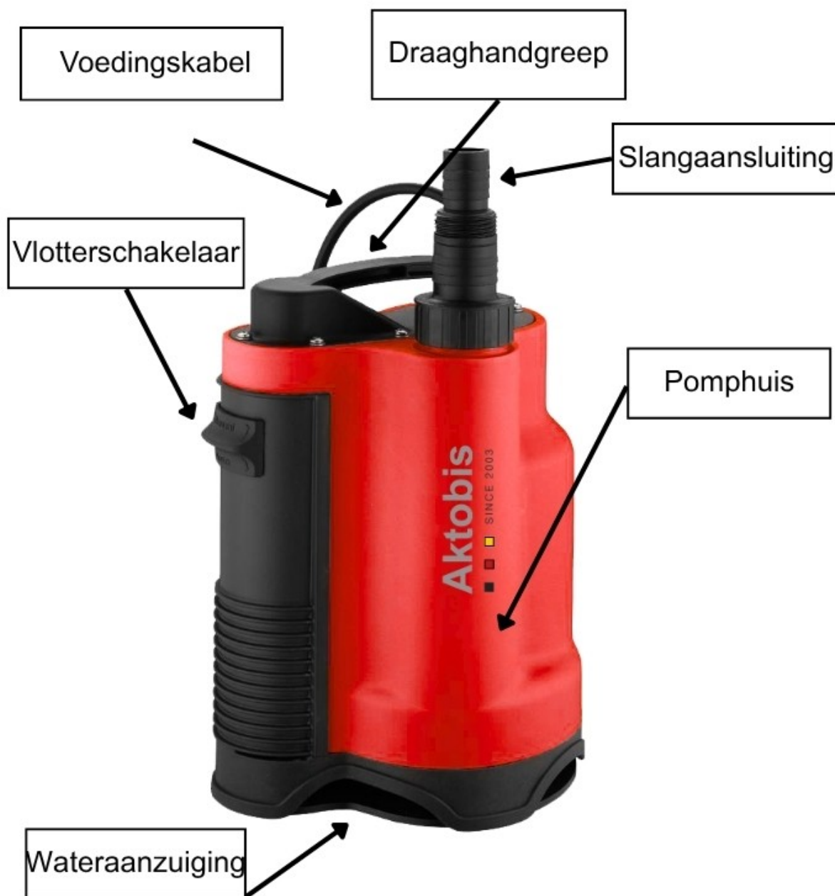
Afb. 1: Afvalwaterpomp WDH-SP750 – Belangrijkste onderdelen.
